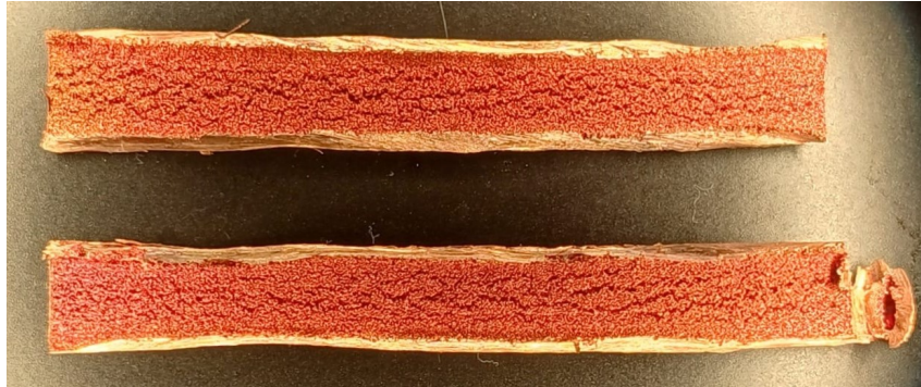
Figura 26 – Tubo de calor aberto longitudinalmente.
