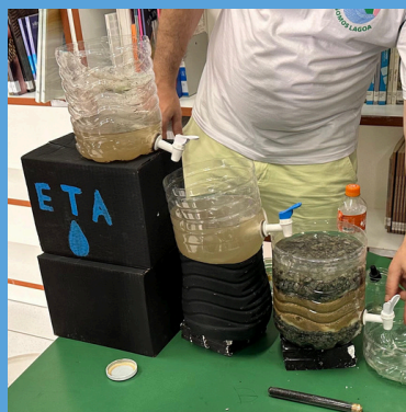
Estação de Tratamento de Água
