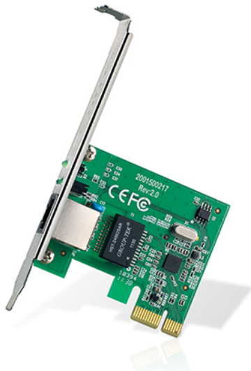
Figura 27 – Placa de Rede adicional do nodo mestre
