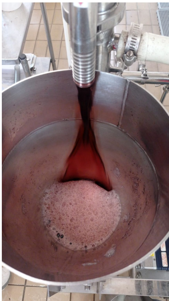
Figura 11. Tanque de alimentação da membrana no processo de MF e UF da amostra da jabuticaba.
