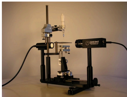
Figura 3 – Goniômetro, fabricado pela Ramé-Hart Instruments ®
