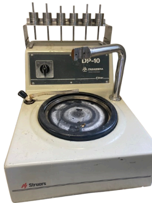
Figura 2 – Máquina de lixar Politriz Semi-Automática DP-10 Panambra Struers
