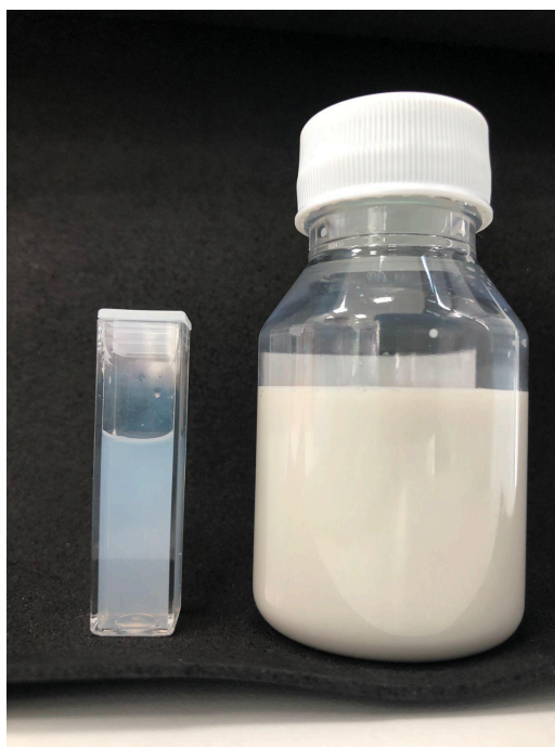
Figura 20. Efeito Tyndall observado na formulação "A2".
