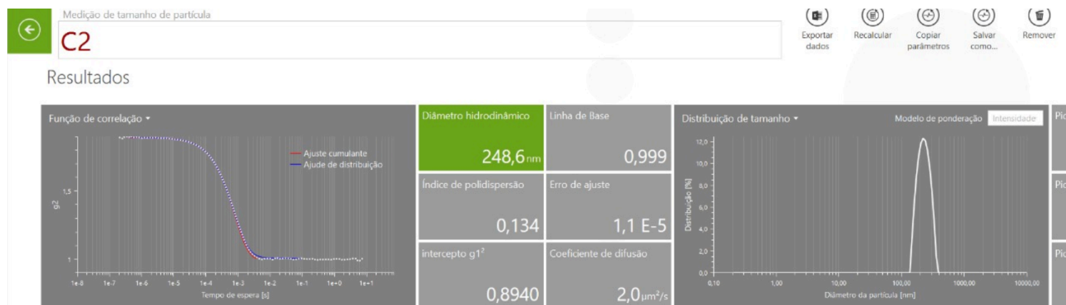
Figura 19. Exemplo da análise de tamanho de partícula e polidispersão através do equipamento Litesizer DLS da marca Anton Paar.
