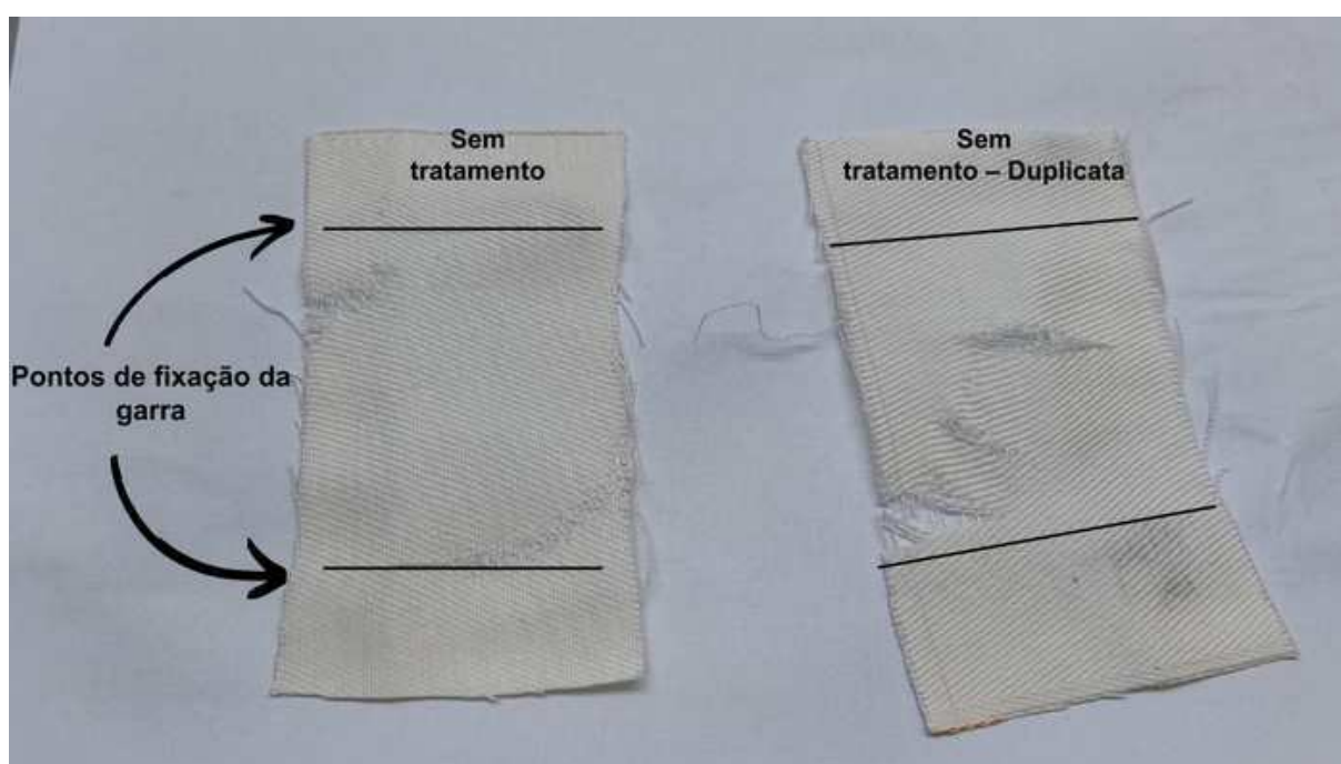
Figura 8 — Amostra sem tratamento com duplicata pós teste de tração mecânica
