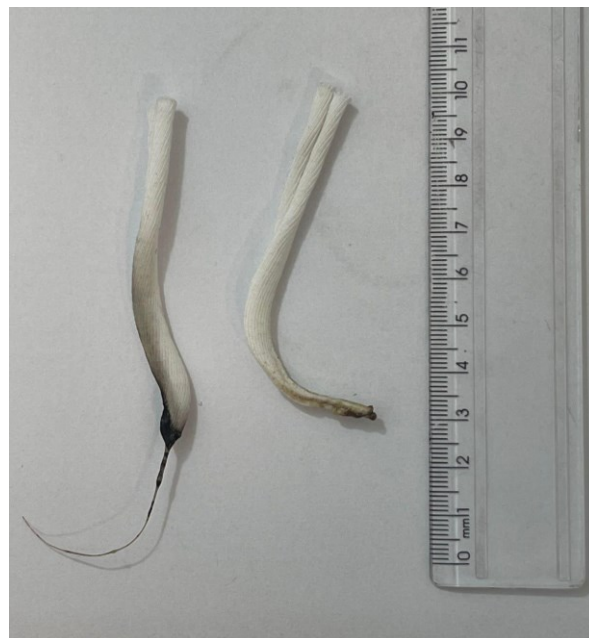
Figura 21 – Amostra de poliéster sem modificação e amostra modificada, após o teste de chama vertical, respectivamente.
