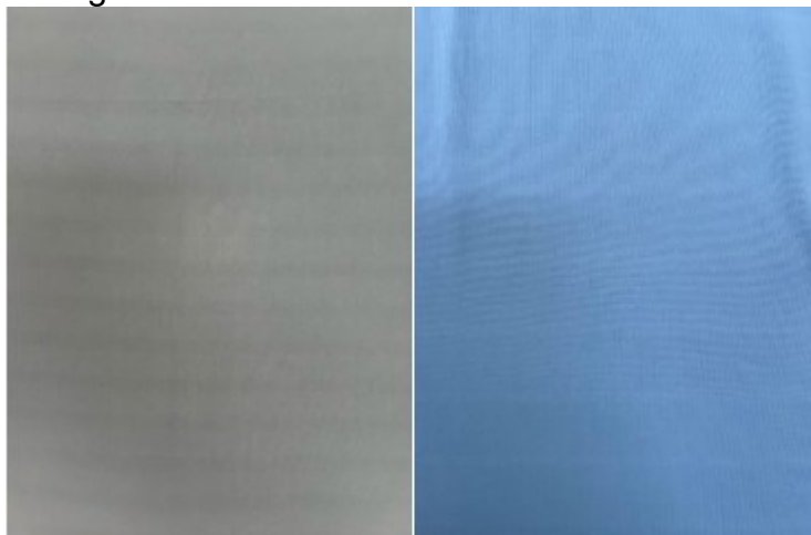
Figura 10 - Malha com defeito de barramento
