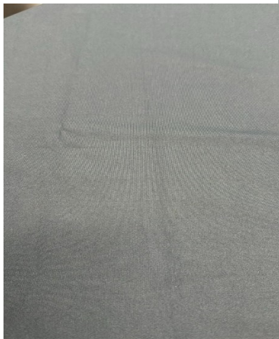
Figura 12 - Malha com defeito de quebras
