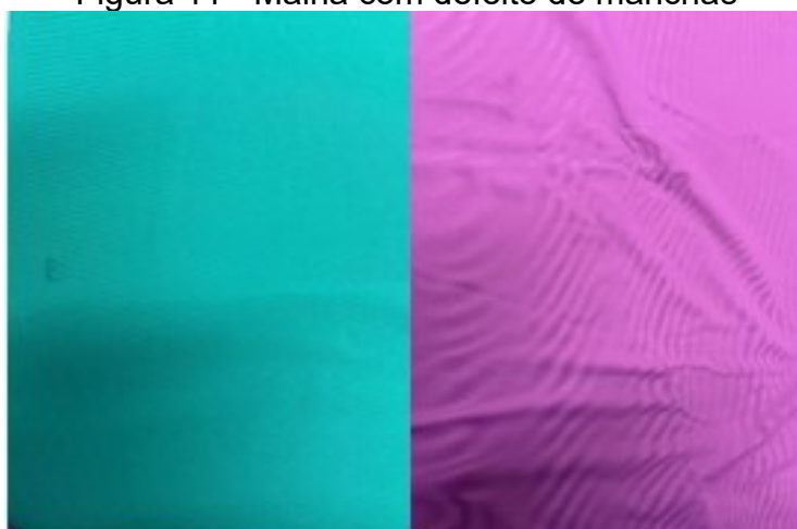
Figura 11 - Malha com defeito de manchas
