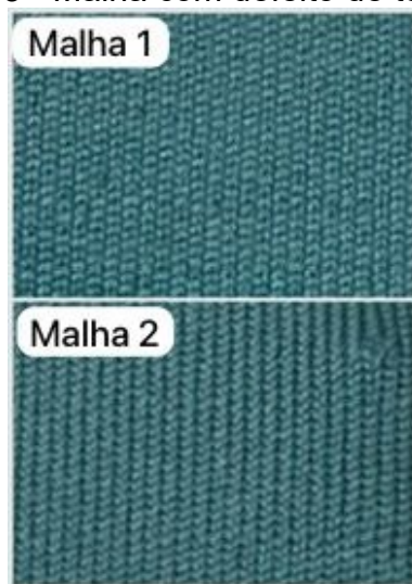
Figura 13 - Malha com defeito de tonalidade
