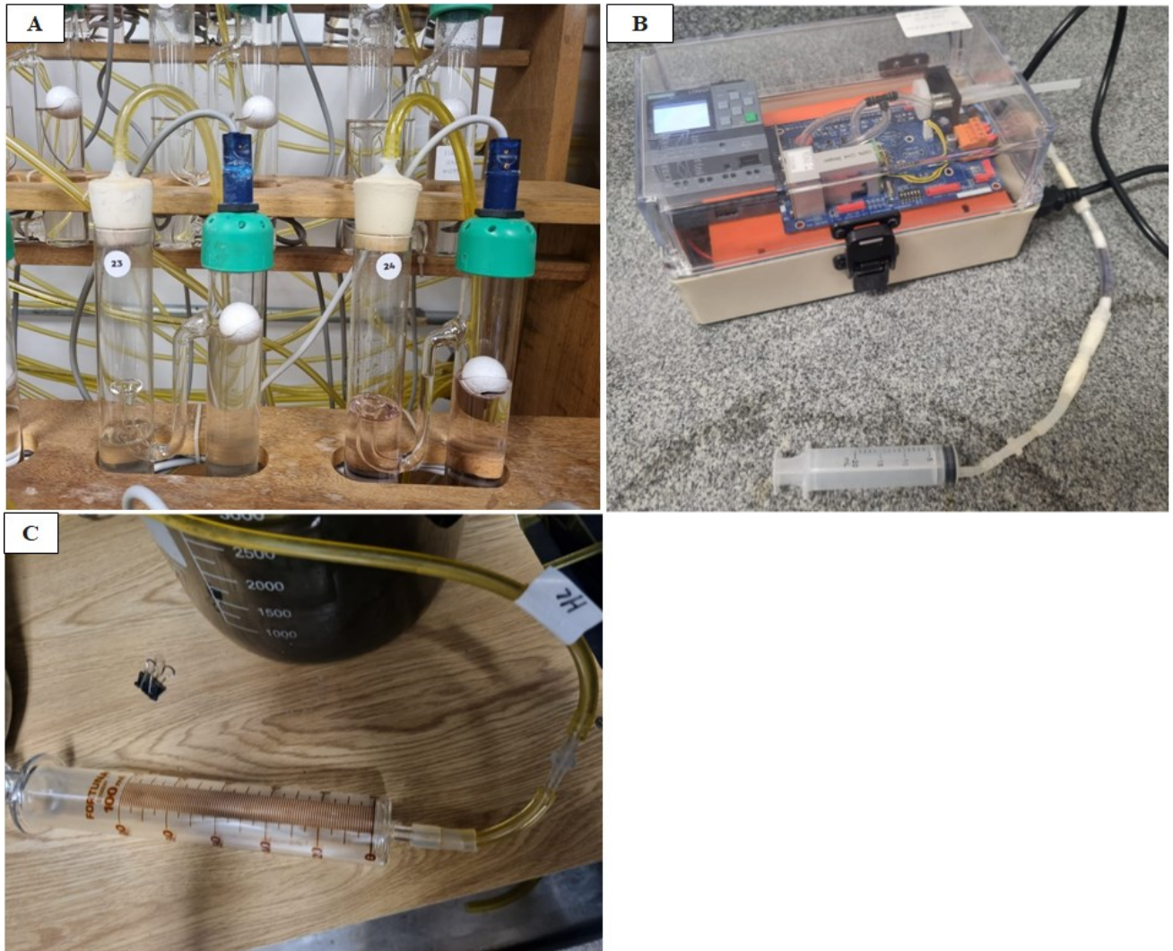
Figura 9 - A) Sistema Automatizado de Medição de Biogás (SAMB) B) Advanced Gasmitter C) seringa calibrada da marca Fortuna Germany
