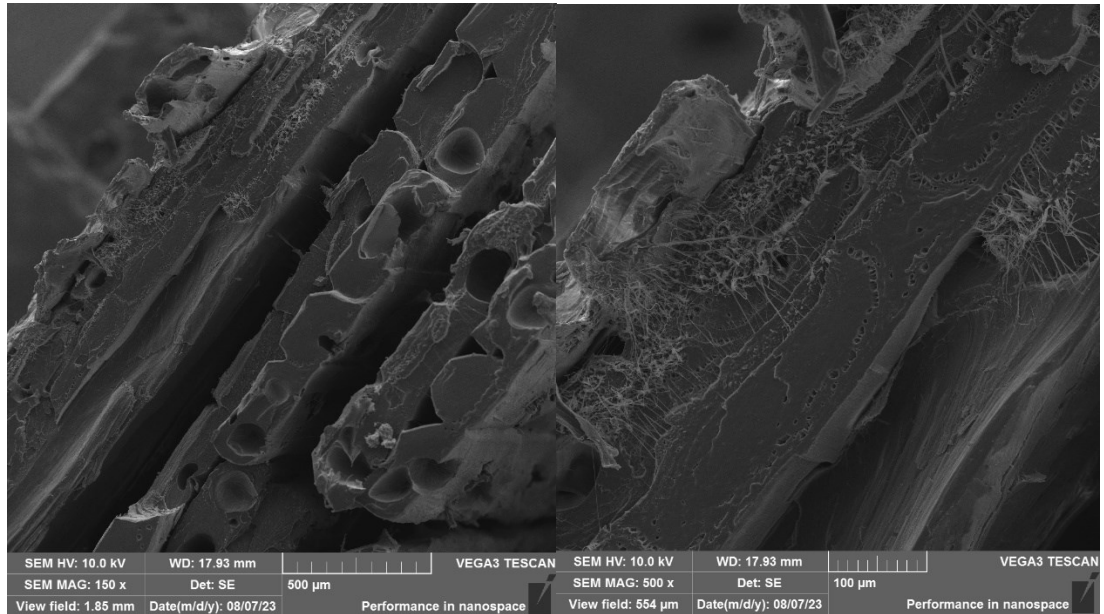
Figura 87 – Imagens de MEV de amostras impressas na zona da fratura.
