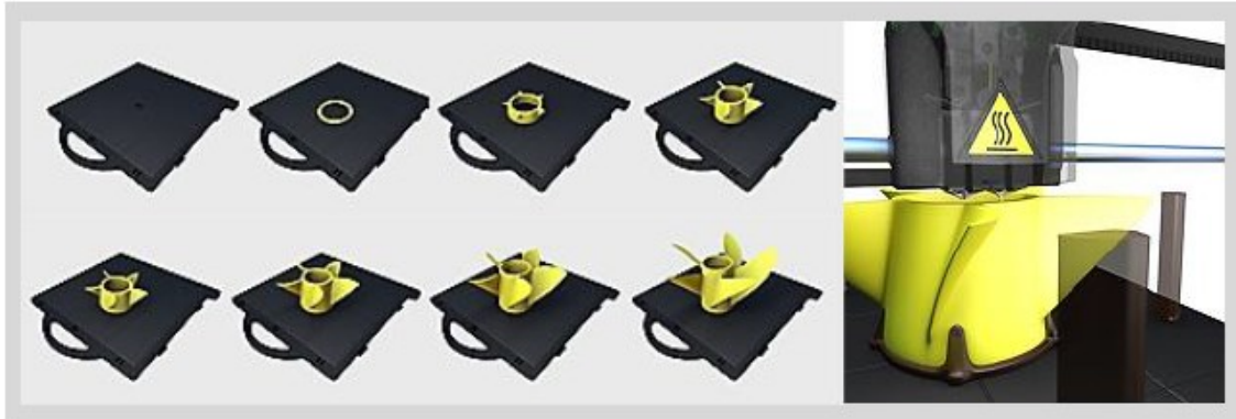
Figura 13: Evolução do processo de fabricação de hélices utilizando a tecnologia FDM (BLANCO, 2019).
