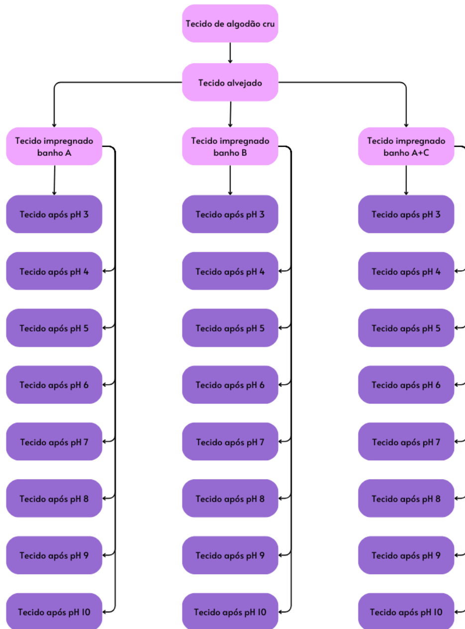
Figura 13 - Esquematização da Análise Colorimétrica
