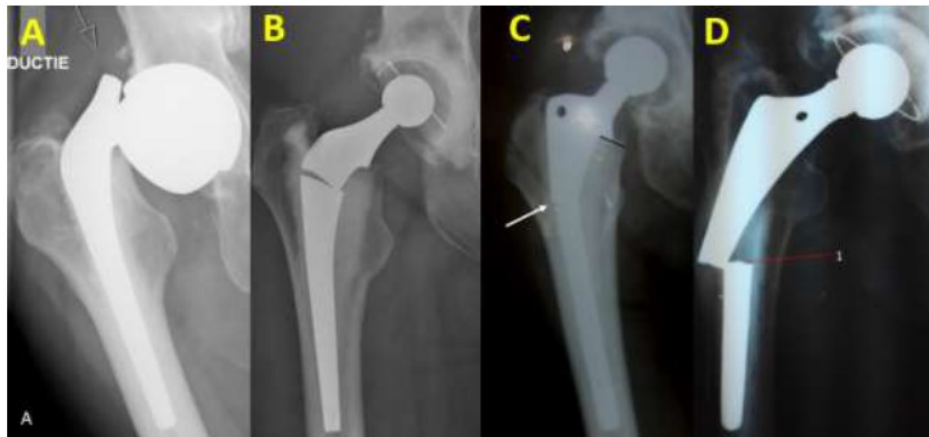
Figura A8 – Radiografias de hastes femorais fraturada
