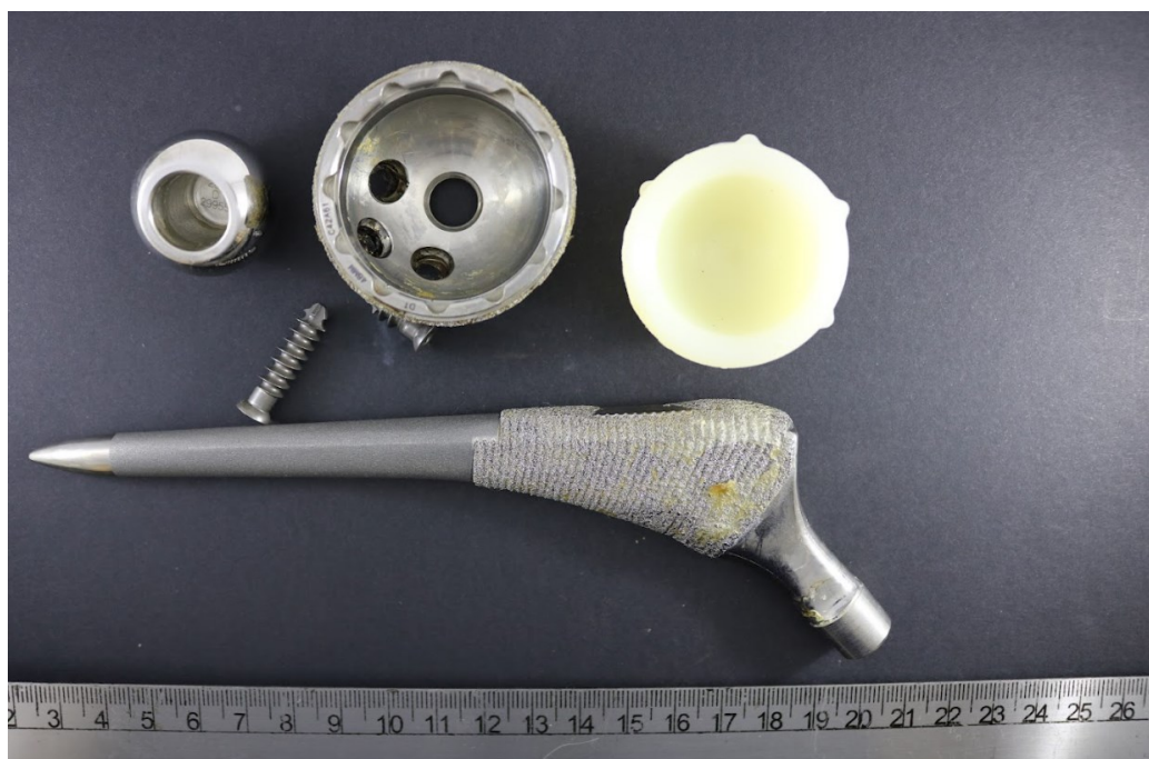
Figura C7 – Explante CNAEx-INTO-339 pertencente ao grupo B do estudo
