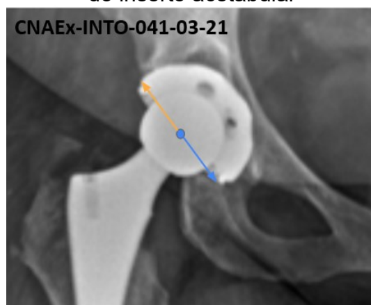
Figura 59 – Radiografia dos explantes de quadril sem indicação de dissociação do inserto acetabular
