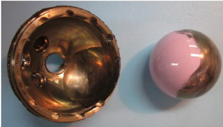
Figura 32 – Significante dano na cabeça femoral e copo acetabular metálico devido ao contato direto
