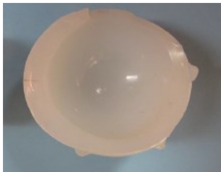
Figura 33 – Deformação plástica em formato de elipse, sofrido pelo inserto acetabular
