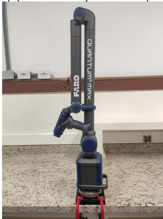
Figura 63 – Equipamento do braço de scanner para digitalização
