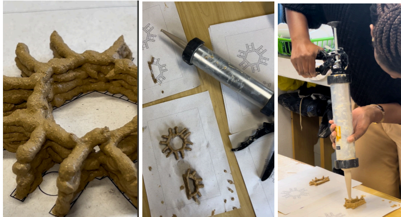
Figura 68: Produção dos módulos da estrutura em escala reduzida. Fonte: Elaborada pelas autoras (2024)
