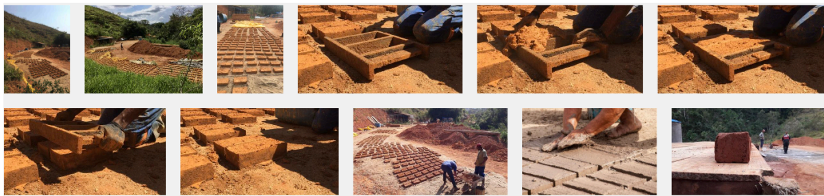
Figura 5: Processo de produção de adobes. Imagens: Cabana do Lago- Matéria Base (2024)
