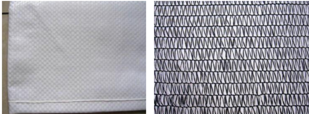
Figura 15- Tecido plástico e tela plástica Fonte: PP woven bag (2015); Biopack (Hiperadobe) (2015). apud Santos (2015).
