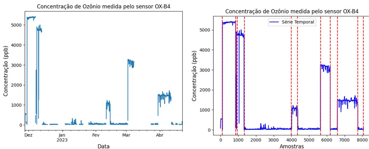
(a) Série temporal do sensor 1 depois de remover valores fora de intervalo (b) Pontos de alteração da linha base no sensor 1 detectados pelo algoritmo PELT
