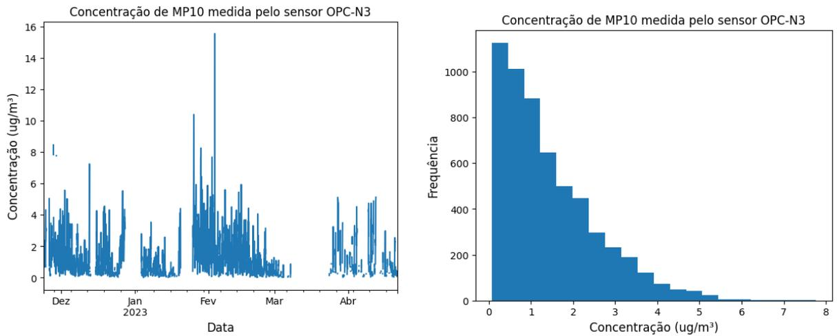
(a) Série temporal do sensor depois de remover valores fora de intervalo (b) Histograma das leituras pré-processadas do sensor OPC-N3
