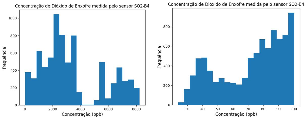
(a) Histograma das leituras do sensor 1 SO<sub>2</sub>-B4 (b) Histograma das leituras do sensor 2 SO<sub>2</sub>-B4
