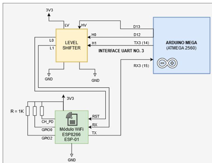
Figura 74 – Interface entre o microcontrolador e o módulo de comunicação Wi-Fi
