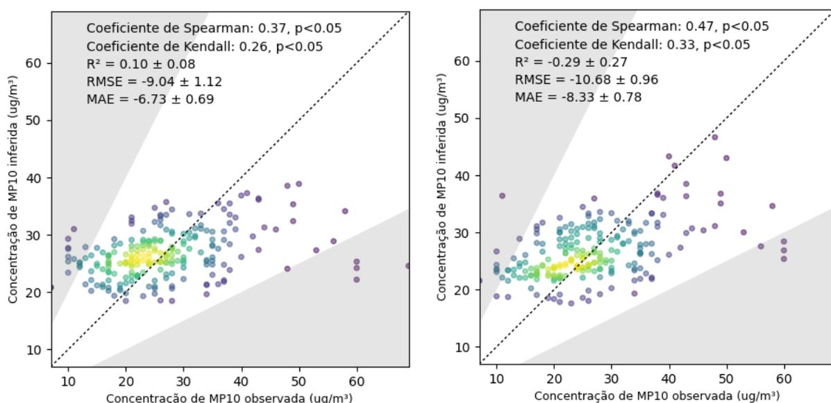
(a) Utilizando uma regressão linear multivariada considerando a temperatura obteve-se um  $R^2$  de 0.10 e  $\rho$  de 0.37 (b) Utilizando uma rede neural Perceptron Multicamadas considerando a temperatura obtiveram-se valores de  $\rho$  de 0.47 e 0.33
