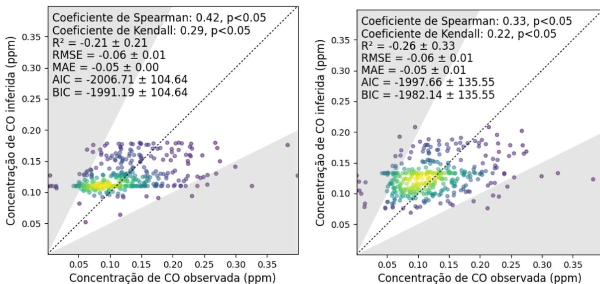
(a) Utilizando modelo de regressão com uma rede neural Perceptron Multicamadas; variáveis independentes: leituras de sensores CO-B4, NO2-B43F e OX-B431 (1)
