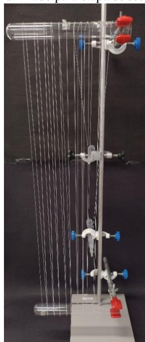
Figura 18 – Aparato utilizado para etapa de secagem dos filamentos.
