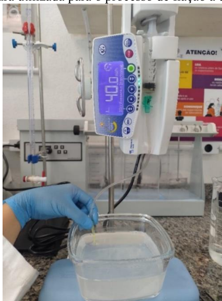
Figura 10 – Estrutura utilizada para o processo de fiação a úmido verticalizado.
