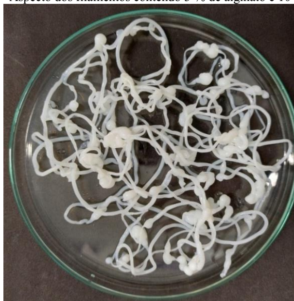
Figura 22 –Aspecto dos filamentos contendo 3 % de alginato e 10 % de ZnO.
