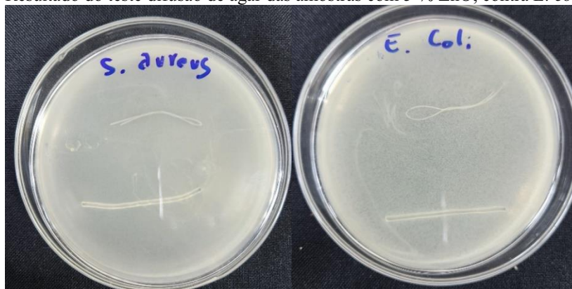
Figura 28 – Resultado do teste difusão de ágar das amostras com 5 % ZnO, contra E. coli e S.aureus .
