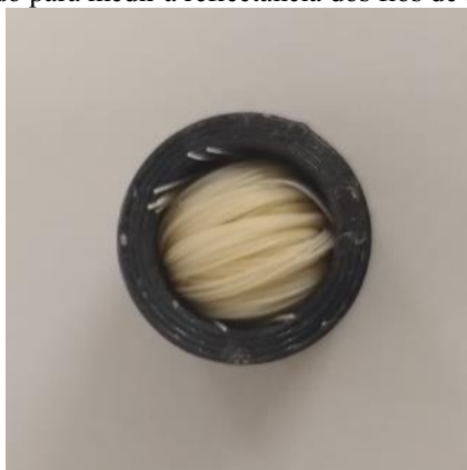
Figura 15 – Aparato utilizado para medir a reflectância dos fios de alginato com óxido de zinco.
