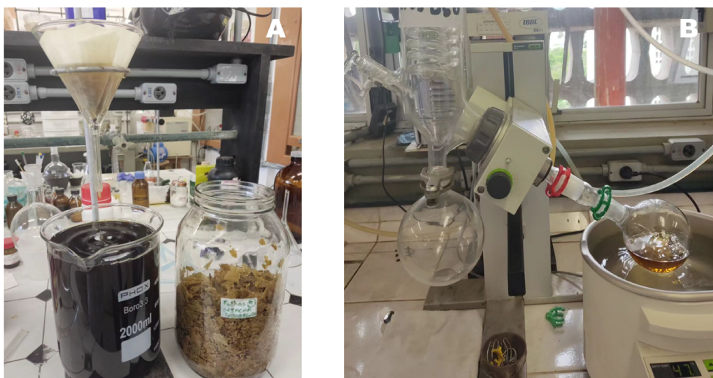
Figura 4. A) Filtragem dos extratos e B) Solvente removido sob pressão reduzida em um evaporador rotatório, resultando em extratos brutos hidroalcoólicos (70% etanol) de calos de cotilédone de P. setacea cv. BRS Pérola do Cerrado.
