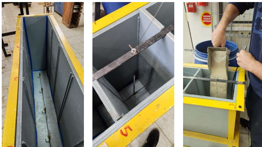
Figura 52 - À esquerda tanque selado, no centro a corrente fixada e à direita o início do enchimento.
