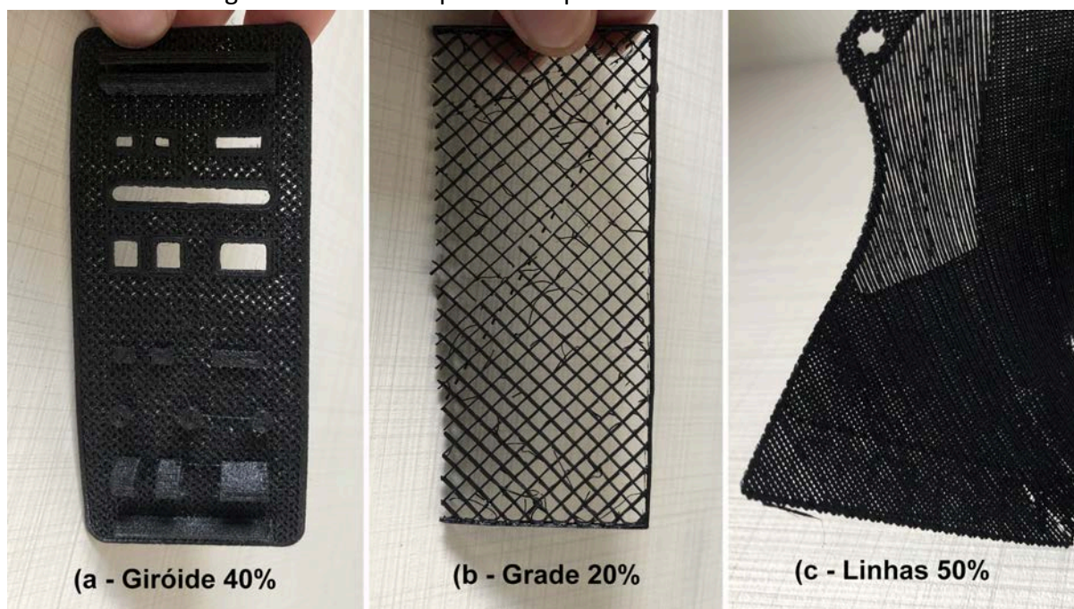
Figura 96: Testes de padrão de preenchimento do Cabedal
