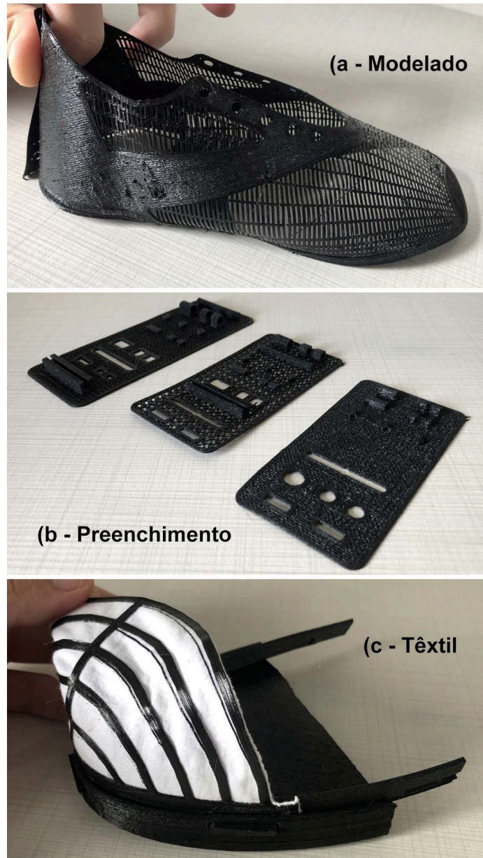
Figura 89: Testes de produção do Cabedal.
