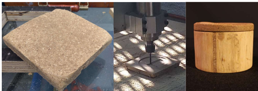
Figuras 2a e 2b: a- Compósito desenformado; b- Usinagem da peça c- Saleiro em madeira e compósito de acrocarpo. Fonte: elaborado pelos autores
