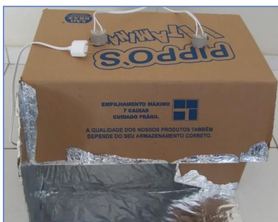
Figura 2: Instalação dos fios elétricos nos bocais. Fonte: elaborado pelos autores.
