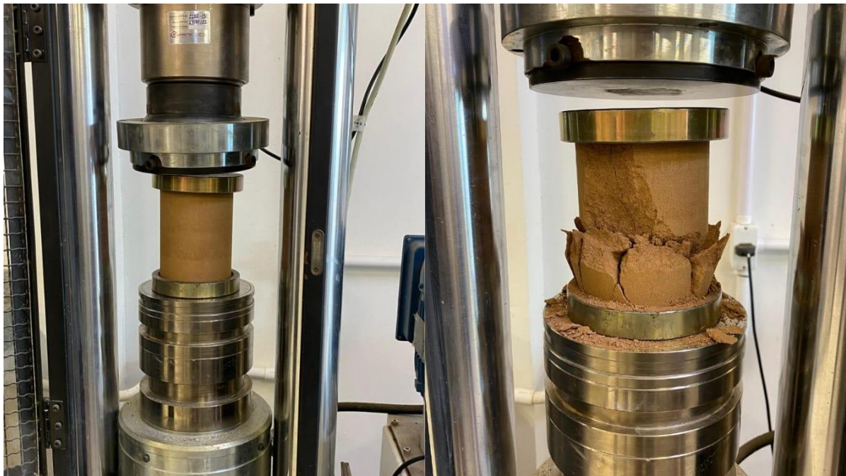
Figura 3: CPs elaborados para ensaio de resistência mecânica: (a) antes e (b) após o rompimento. Fonte: autores.
