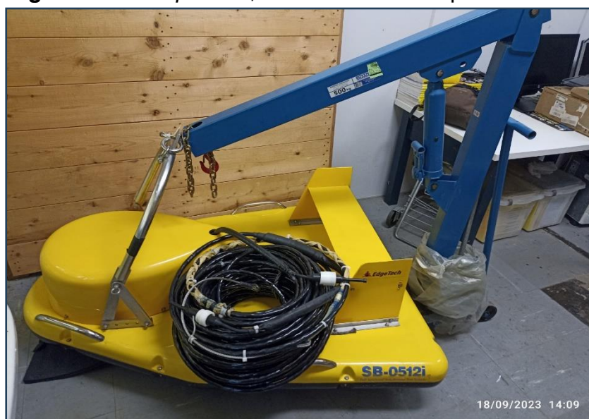
Figura 12 – Chirp 0512i, fonte acústica do tipo ressonante.
