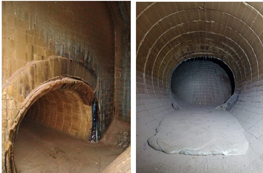
Figura 16 – Acúmulo de cinzas fundidas no canhão FTB
