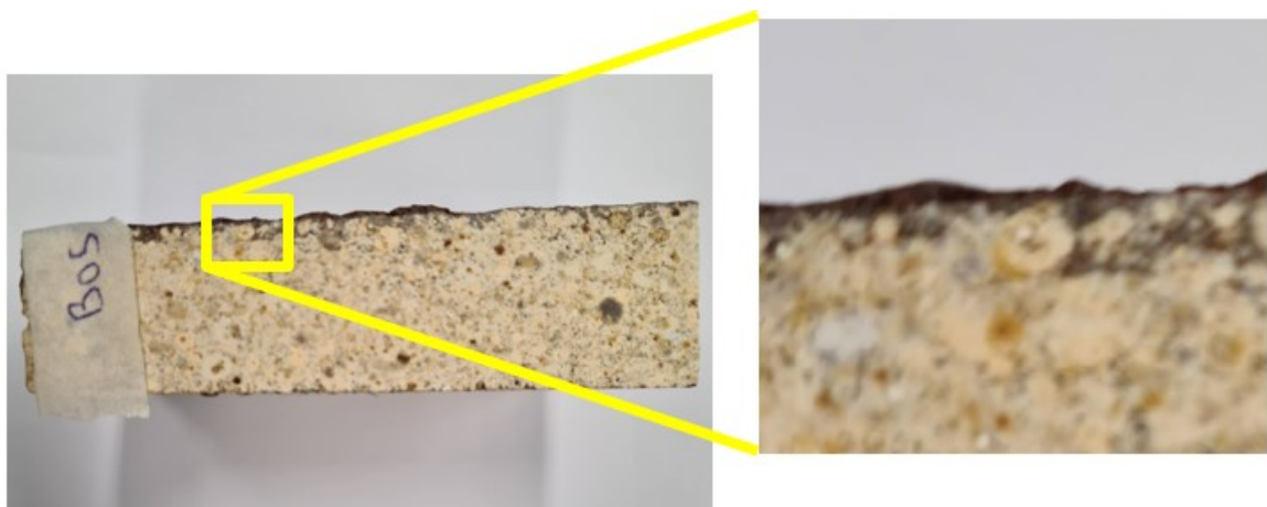
Figura 26 – Amostra experimentada de refratário destacando a penetração da incrustação superficial.
