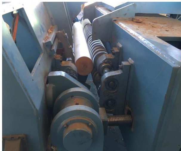
Figura 2 – Exemplo de torno laminador sem fuso.
