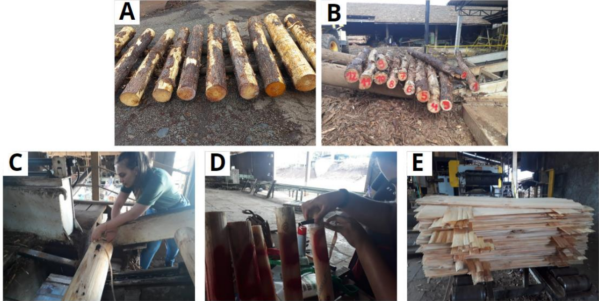
Figura 3 – Etapas do processo de avaliação do rendimento na laminação. Toras selecionadas para avaliação (A); Toras identificadas (B); Mensuração da circunferência da tora após arredondamento (C); Mensuração da circunferência do rolo-resto (D); Fardo de lâminas de cada tora (E).
