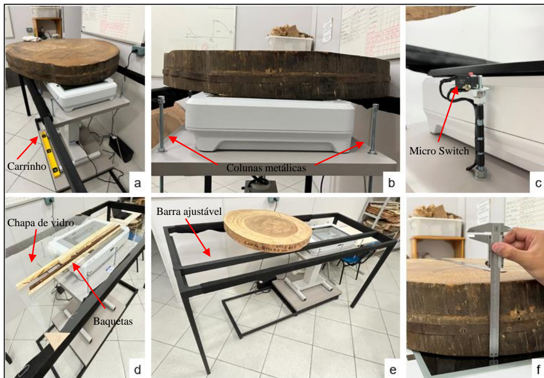
Figura 3 – Equipamento final, sistema de mesas de digitalização. (a) detalhamento geral, com amostra > 85 cm de diâmetro; (b) vista lateral, amostra suportada sobre o scanner; (c) Coluna metálica e Limit Switch; (d) acessório 1, chapa de vidro para baquetas > 42 cm; (e) acessório 2, barra de suporte ajustável para discos < 85 cm de diâmetro; (f) mensuração da distância entre a amostra de madeira e o vidro do scanner.
