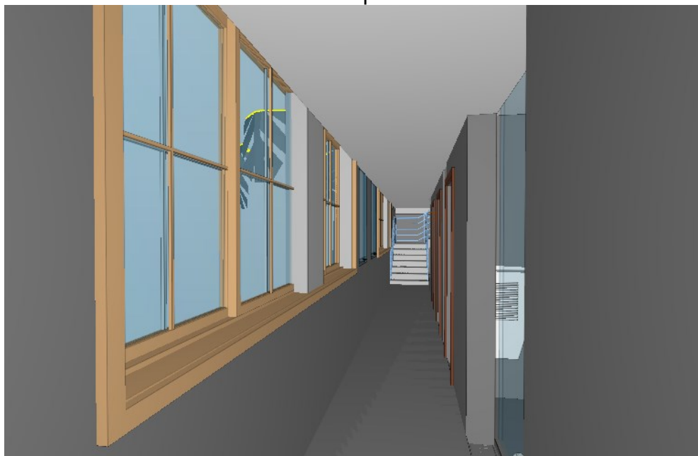
Figura 100 – Vista do corredor do primeiro pavimento, indicando intersecção entre forro e esquadrias.
