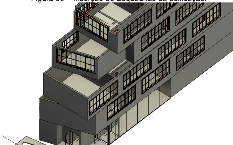
Figura 66 – Inserção de Esquadrias da edificação.
