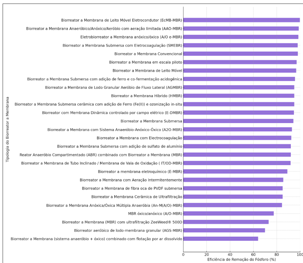
Figura 8 – Avaliação da eficiência da remoção do fósforo através de diferentes configurações de biorreatores a membrana
