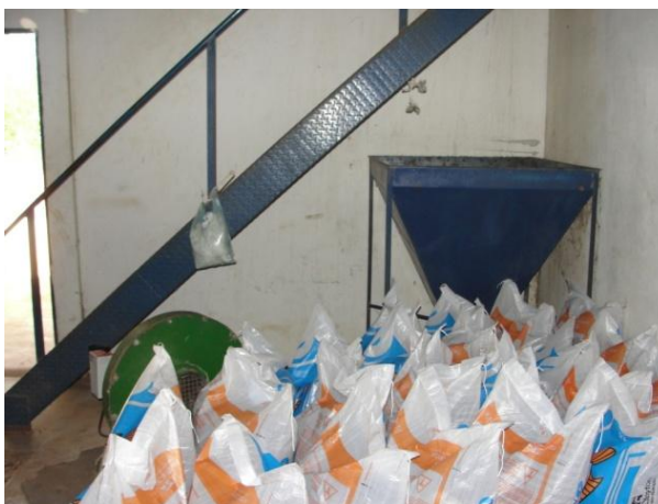
Figura 18. Sistema de transporte de ração utilizado e desenvolvido pela empresa Escama Forte Piscicultura. (A) Local para despejar a ração, onde através do soprador acoplado a ração chegará ao
