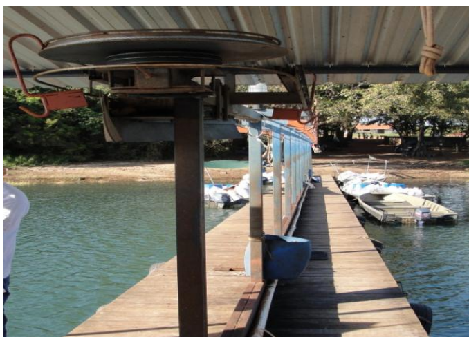
Figura 25. Os ganchos tracionados por motor utilizados na despesca de tilápias na Geneseas Aquacultura Ltda.
