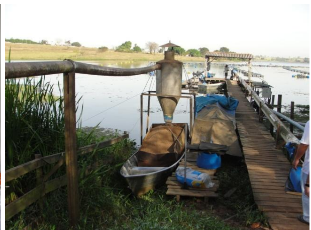
Figura 18. Sistema de transporte de ração utilizado e desenvolvido pela empresa Escama Forte Piscicultura. (A) Local para despejar a ração, onde através do soprador acoplado a ração chegará ao
