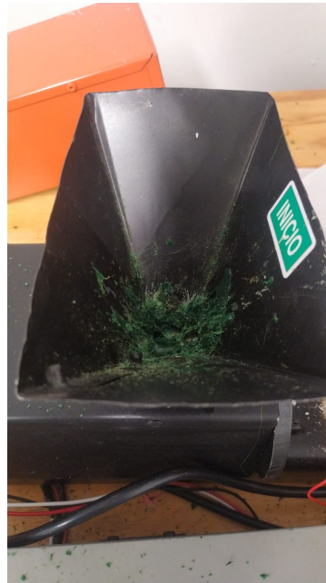
Figura 40 – PLA retraído na zona de alimentação
