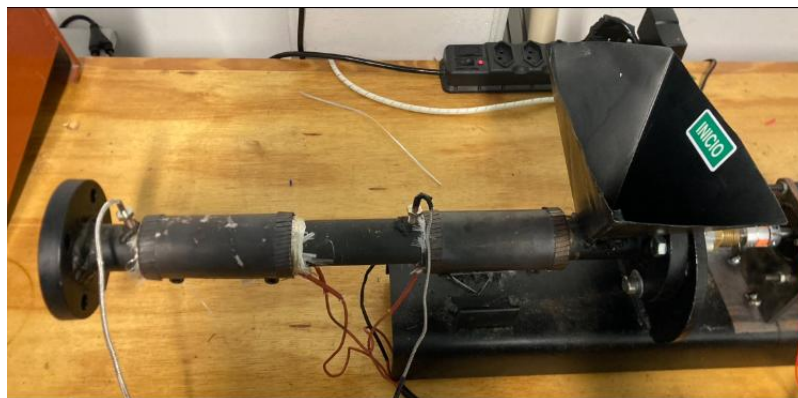
Figura 26 – Montagem Cilindro, Molde e Sistema de alimentação
