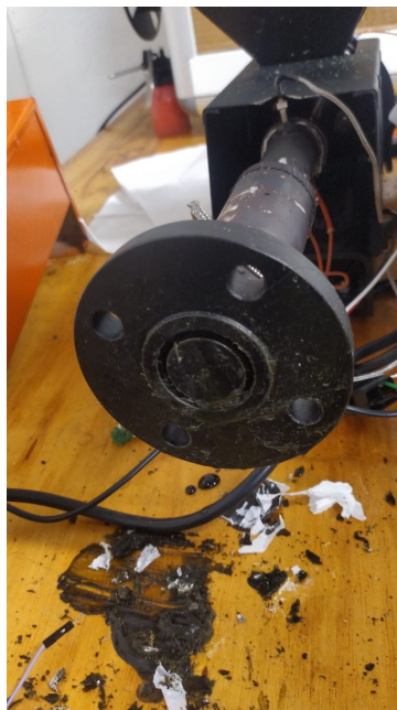
Figura 39 – PLA degradado solidificado
