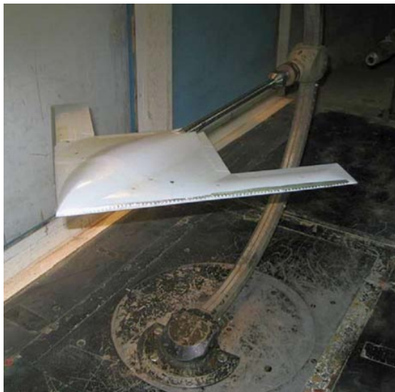
Figura 20 – Teste em túnel de vento do protótipo impresso
