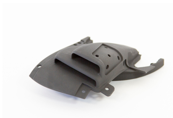
Figura 7 – Entradas de Freio Impressas em 3D da Alfa Romeo para Testes em Túnel de Vento
