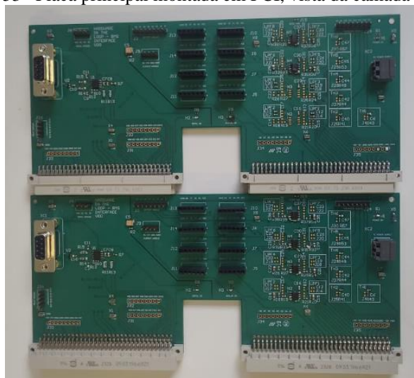
Figura 53– Placa principal montada em PCI, vista da camada de cima.
