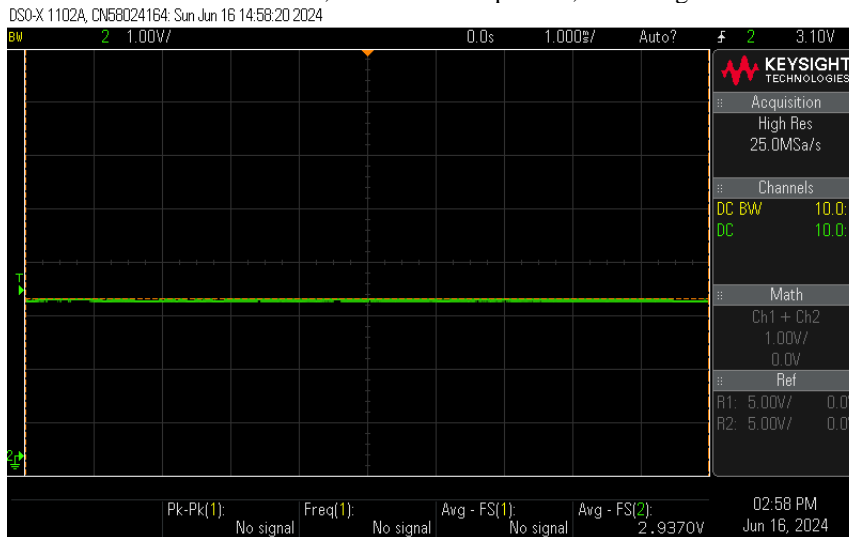
Figura 67 – Teste em BMS FDC-2S-02, tensão de 3V aplicada, sinal do gate do MOSFET da placa.
