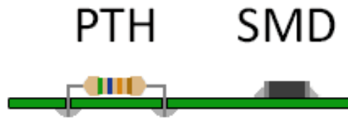
Figura 23 – Amostra de componentes PTH, à esquerda, e SMD, à direita, soldados em PCI de FR-4.
