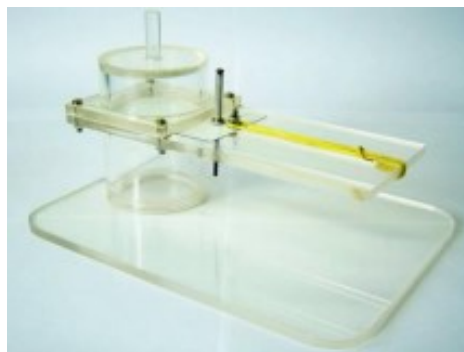
Figura 10 – Aparato para medição de tempo de dispersão.
