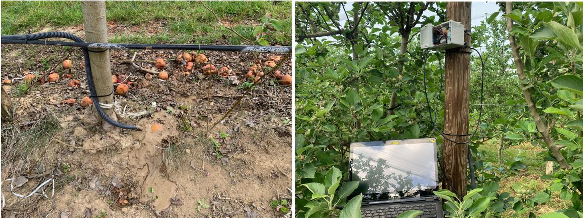
**Figura 5.** À esquerda a sonda instalada na parcela de maçã, à direita o momento de configuração do datalogger. (Fonte: Autora)
