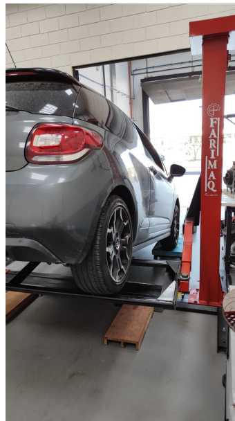
Figura 15 – Veículo inclinado para medição do CG
