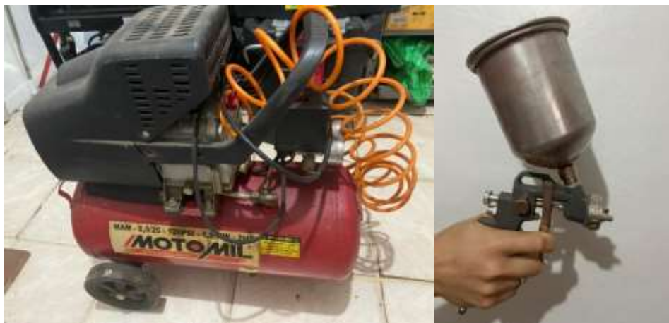
Figura 11– Compressor e pistola utilizados na pintura das placas
