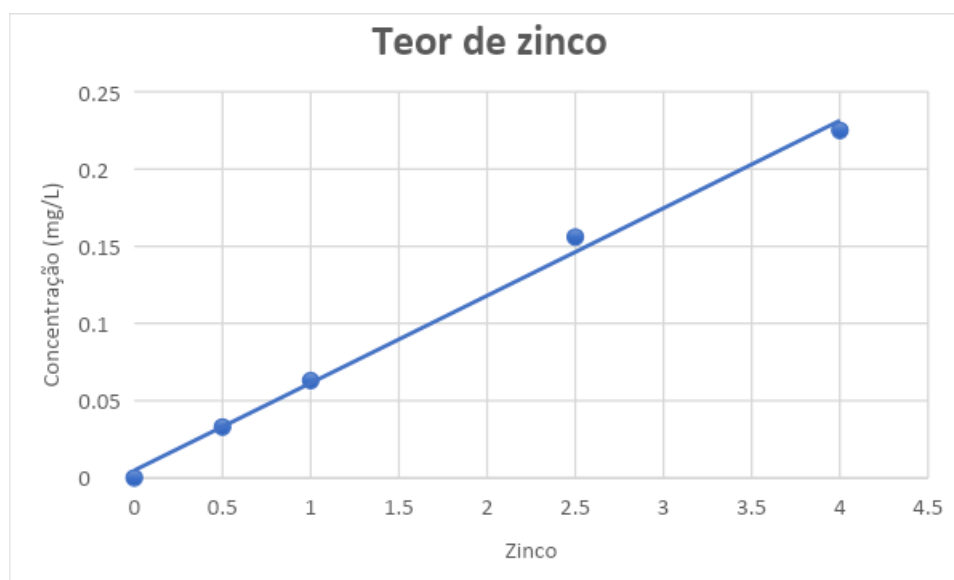
Figura 7. Curva de calibração para a determinação do teor de Zn nas amostras obtida por FAAS.
