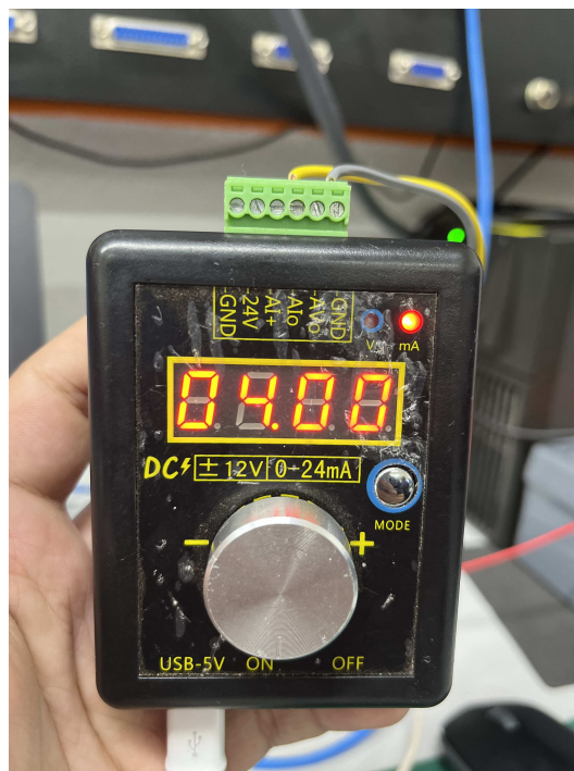
Figura 25 – Gerador de sinal configurado para 4-20mA.
