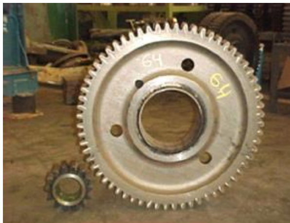
Figura 10 - Pinhão e engrenagem utilizados no motor de tração e rodeiro
