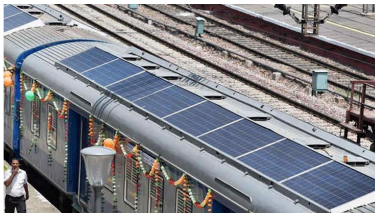
Figura 17: Vagão com painéis fotovoltaicos
