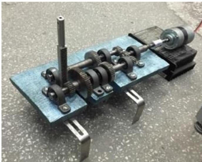
Figura 16: Protótipo de sistema de captação de energia a partir da vibração do trilho.
