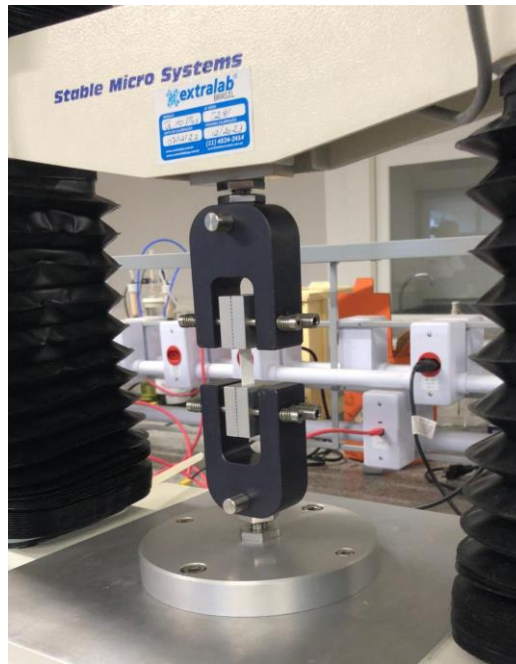
Figura 22 – Texturômetro utilizado para ensaio de tração das nanofibras.
