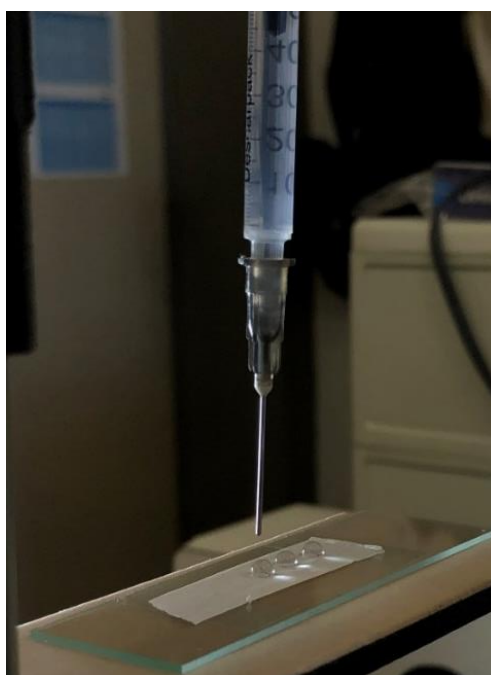
Figura 20 – Medidas de Ângulo de contato realizadas em três regiões distintas da amostra.
