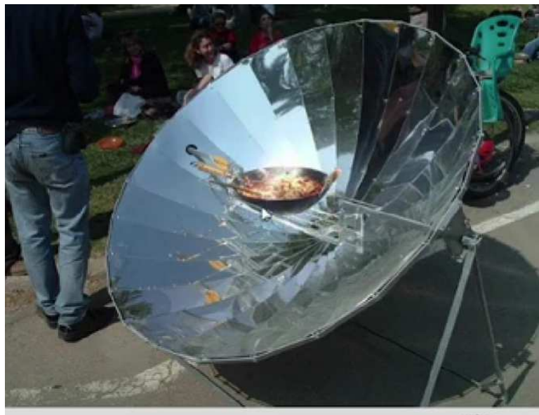
Figura 1 - Coletor solar de espelhos (Fonte: Neperma)
