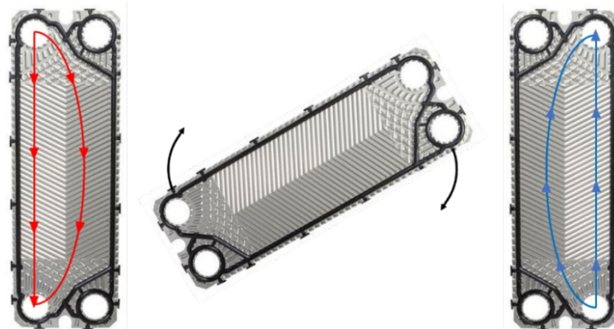
Figura 32 - Procedimento de montagem de placas.
