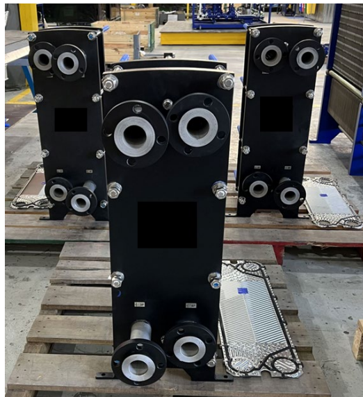
Figura 34 - Trocadores de calor a placas montados utilizados nesse trabalho.
