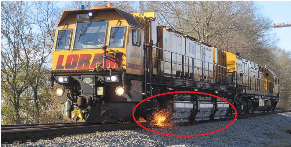
Figura 28 – Trilho sendo esmerilhado.
