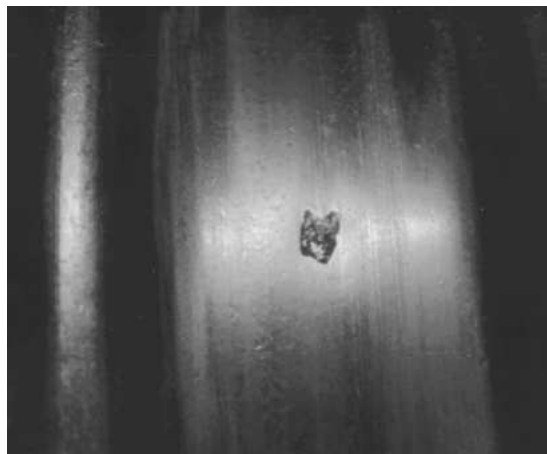
Figura 9 – Roda com spalling .
