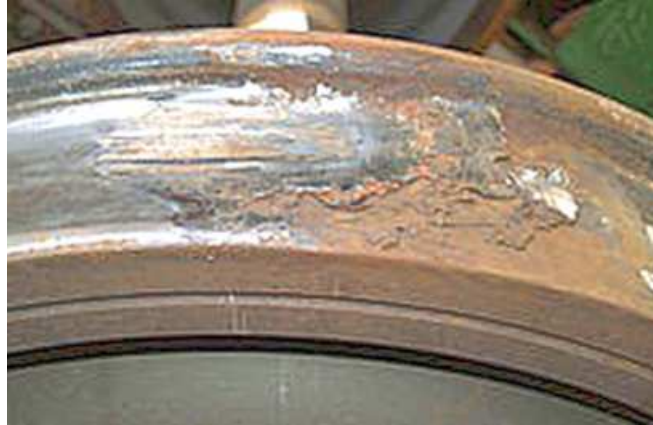
Figura 7 – Calo na roda.
