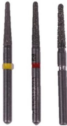
**Figura 7 - Pontas diamantadas tronco-cônicas de extremo arredondado n° 2135, n°2135F e 2135FF (KG Sonrensen, São Paulo, SP, Brasil) utilizadas no preparo.**
