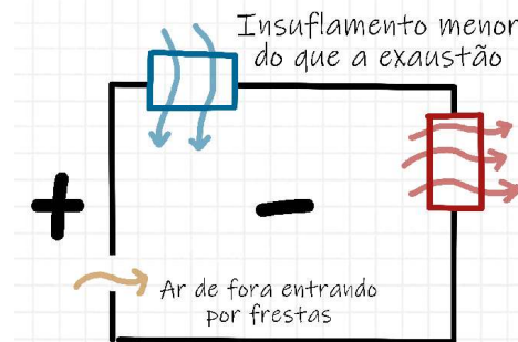
Esquema de fluxos causados por pressão positiva e pressão negativa. Fonte: Autora
