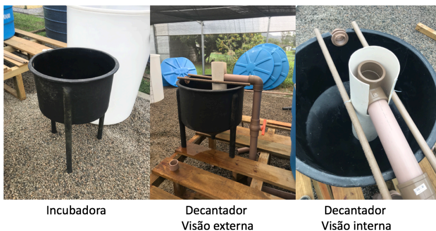
Figura 31. Adequação incubadora para decantador
