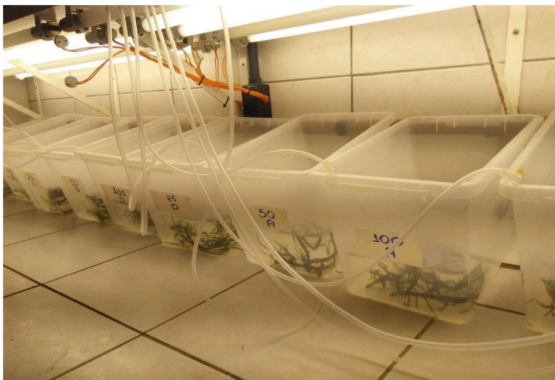
Figura 2. Unidades experimentais distribuídas ao acaso na sala de cultivo da Seção de Macroalgas, durante cultivo com água do mar esterilizada, em caixas de 10 L -1 e mangueiras de silicone para aeração.
