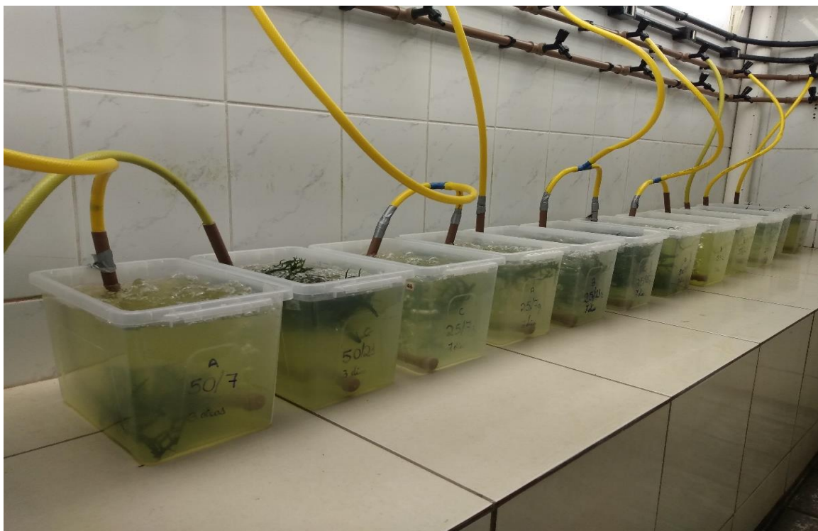
Figura 4. Unidades experimentais distribuídas ao acaso com sistema de mangueiras para aeração.
