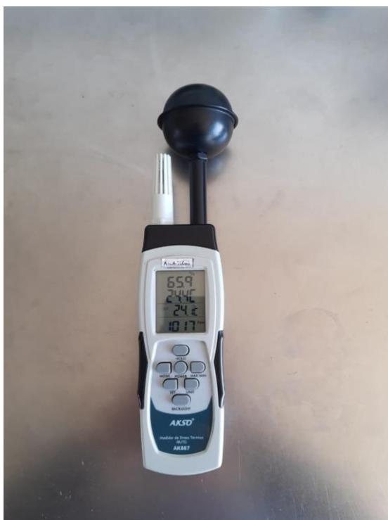
Figura 3. Medidor de stress térmico (IBTUG) - AK887.
