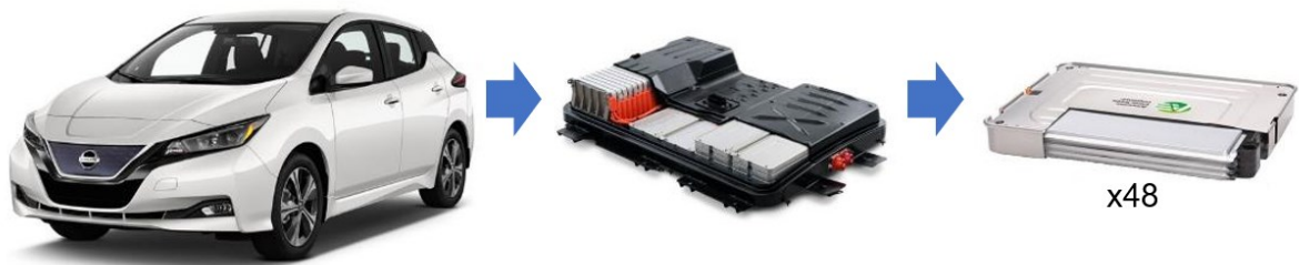
Figura 7 – Da esquerda para direita, apresentação geral do Nissan Leaf, o conjunto de baterias e um dos módulos que compõem o conjunto.
