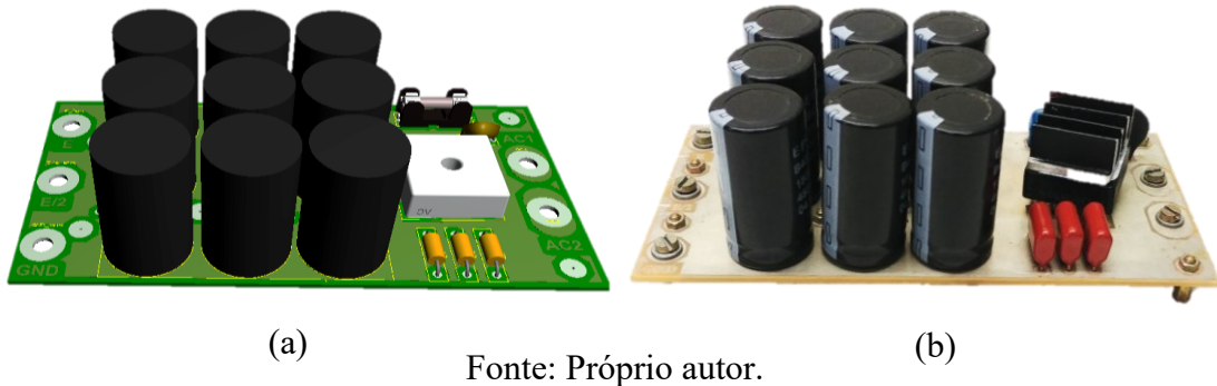
Figura 5-2 – Protótipo do retificador: (a) Projeto em 3D; (b) PCI elaborada.
